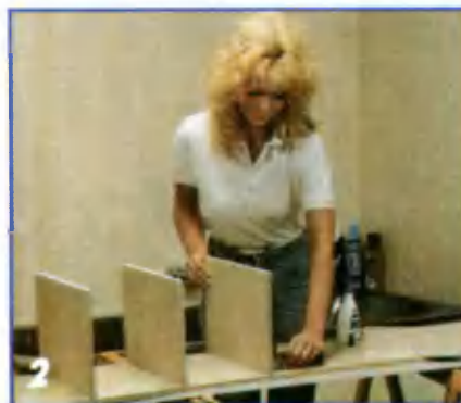
Полочки прикрепляют к стенкам колонки на клею и шурупах строго под прямым углом с помощью металлического угольника.
