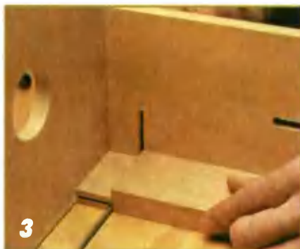
3 Для выпливания заплечиков шипа используется продольное перемещение салазок. Каретка в этом случае служит упором-ограничителем.
