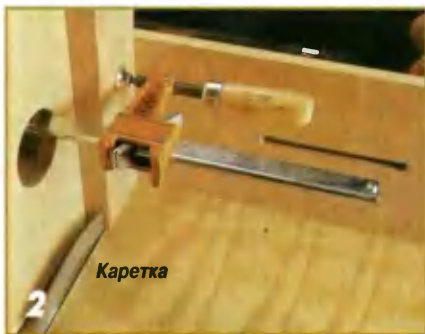
2 Поперечное смещение каретки осуществляется специальным винтовым механизмом. Каретка установлена на салазках, обеспечивающих продольное перемещение всего приспособления.
